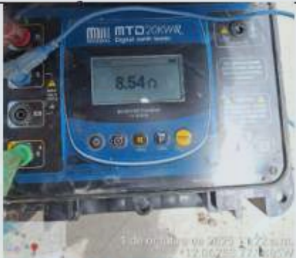
FIGURA 3 – Medición inicial antes de mantenimiento de puesta a tierra.
